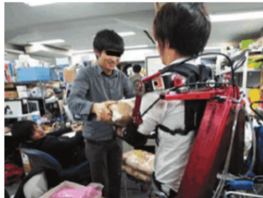
图 4 Hideyuki Umehara 人造肌肉外骨骼机器人<sup>[20]</sup>
