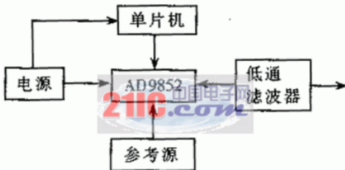
图 2 频率合成器框图
